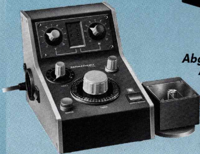
Hochentwickelte Farbmeßtechnik ohne Kanalumschaltung brachte der CA 704 von Wallner – die systembedingten Probleme der Farbmessung blieben trotzdem.
