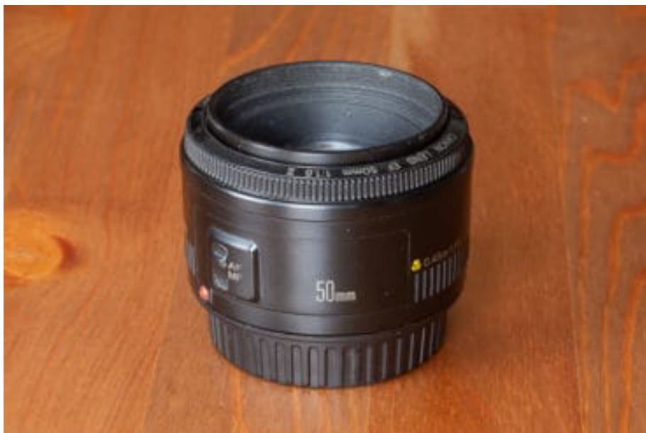
Normalobjektiv mit 50mm Brennweite für Spiegelreflexkamera
