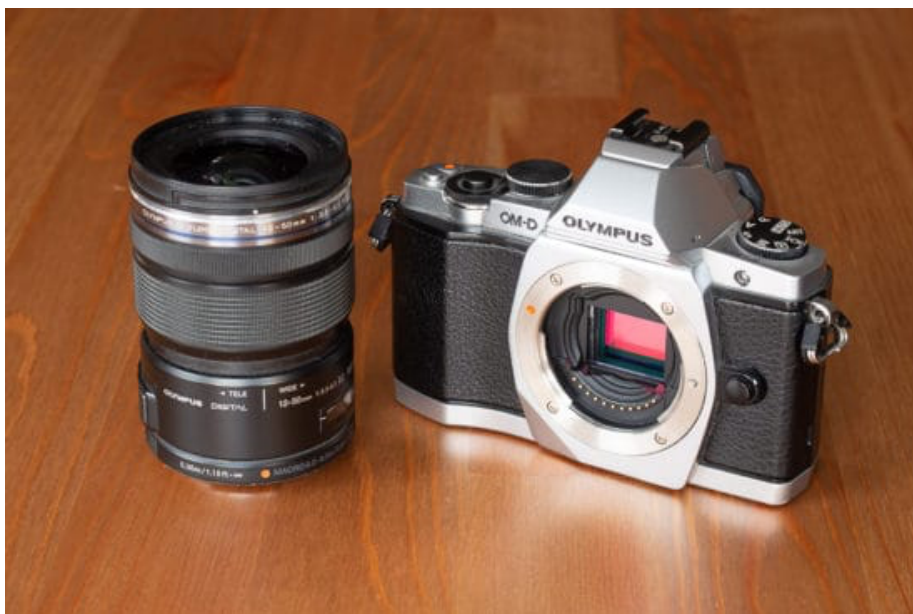
spiegellose Systemkamera mit Wechsel-Objektiv von Olympus
