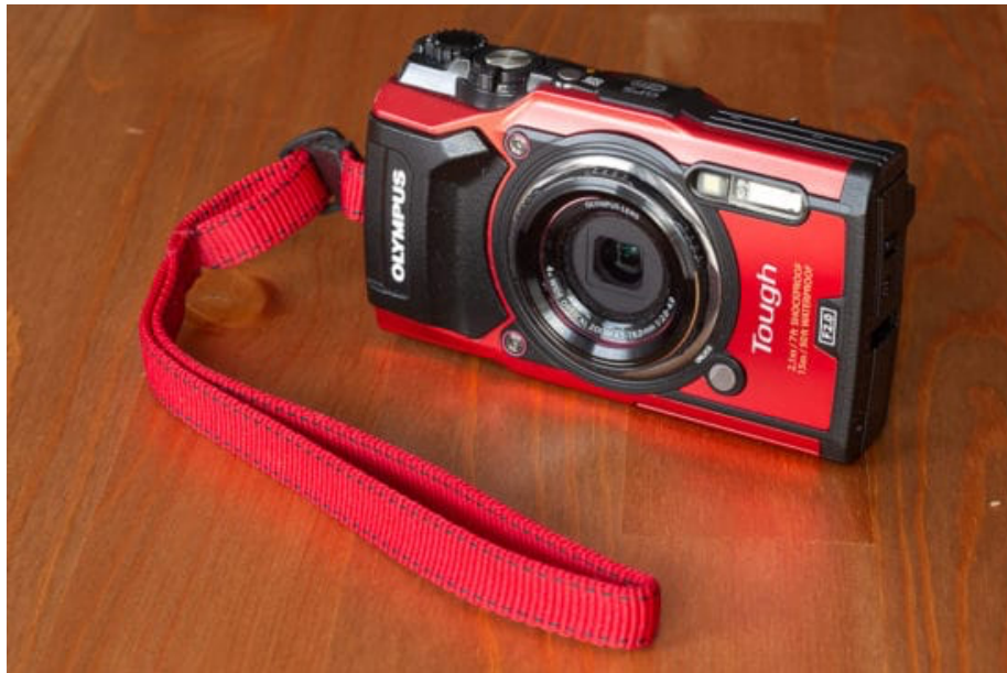
Olympus Kompaktkamera mit fest eingebauter Optik - kein Wechsel des Objektivs möglich
