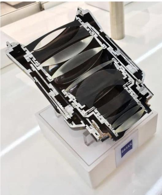
Innenansicht eines Zeiss-Objektives – von: Laserlicht – CC BY-SA 4.0
