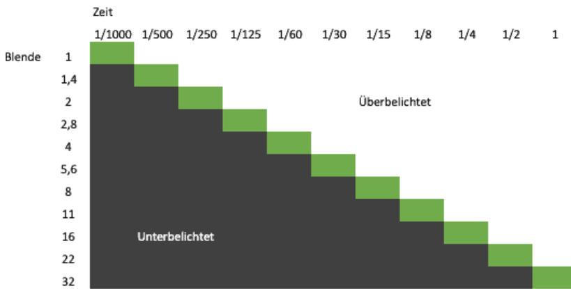
So wäre ein Foto bei dieser Grafik z.B. bei ISO100 mit Blende  $f4$  und einer Zeit von  $1/60$  Sek. korrekt belichtet.
